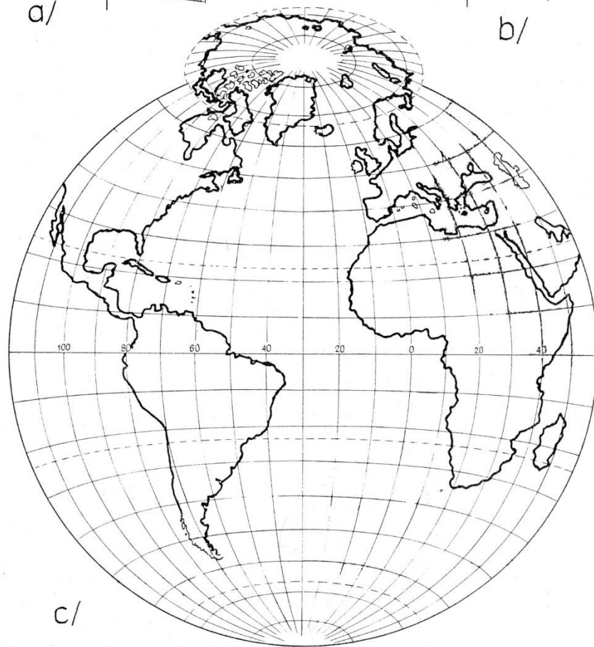
31. ábra Lambert-féle egyenlítői, érintő, területtartó síkvetület. a) A vetítés módjának ábrázolása perspektivikusan, b) A vetítés módszerének ábrázolása metszetben, c) A vetület képe
