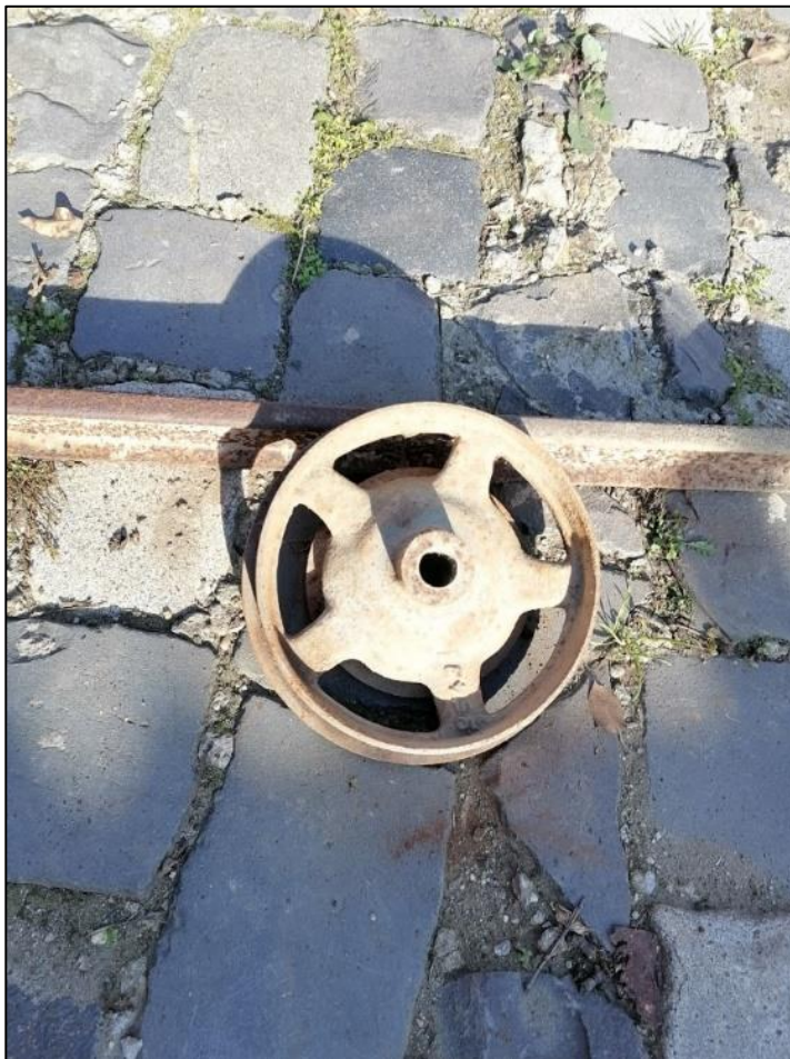
3. kép. A Dénesmajorban kiépített lóré sín és lóré kocsi egy kereke
